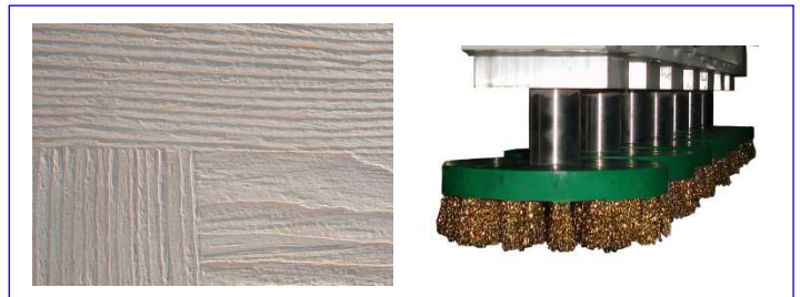
Sistema de estructuración con veta de madera cruzada Sistema di strutturazione con venadellegno incrociata
