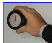
Grit-set con lectura mínima de 0,1 mm Grit-set con lettura minima di 0,1 mm
